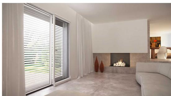
I serramenti dei soggiorni avranno un meccanismo di apertura scorrevole superiore a 1.80 m di larghezza. I restanti saranno a battente dotati di apertura a DK.
